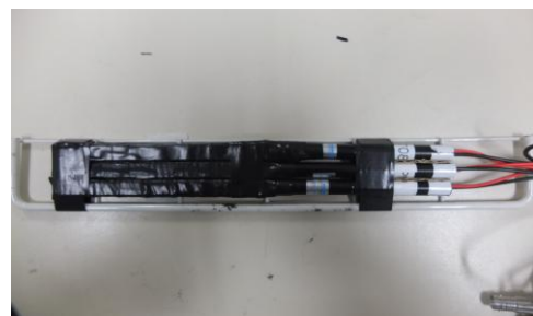
BPM(Beam Profile Monitor) プラスチックシンチレータ100mm x 10mm + PMT : 中性子フラックス形状を測定
