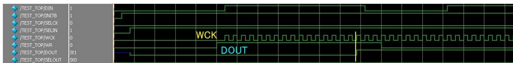
図 6.29: CCR のシミュレーション：17 発目の WCK で DOUT が立ち上がっている
