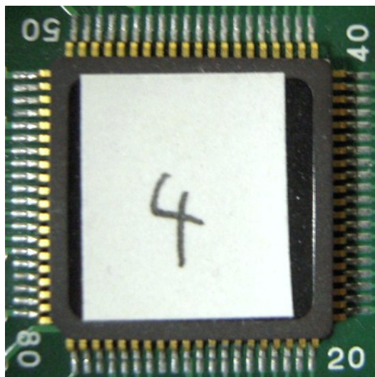
図 4.1: パッケージに封入した読み出し回路
