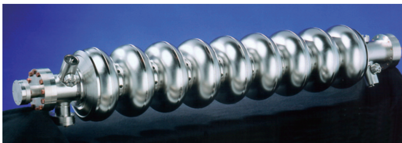
図 1.5: ILC の主線形加速器における 9 個のセルを持つ加速空洞
