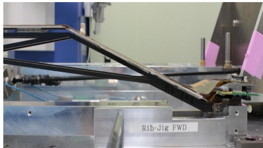
フレキシブル基板が浮きなく 接着ができているか確認
