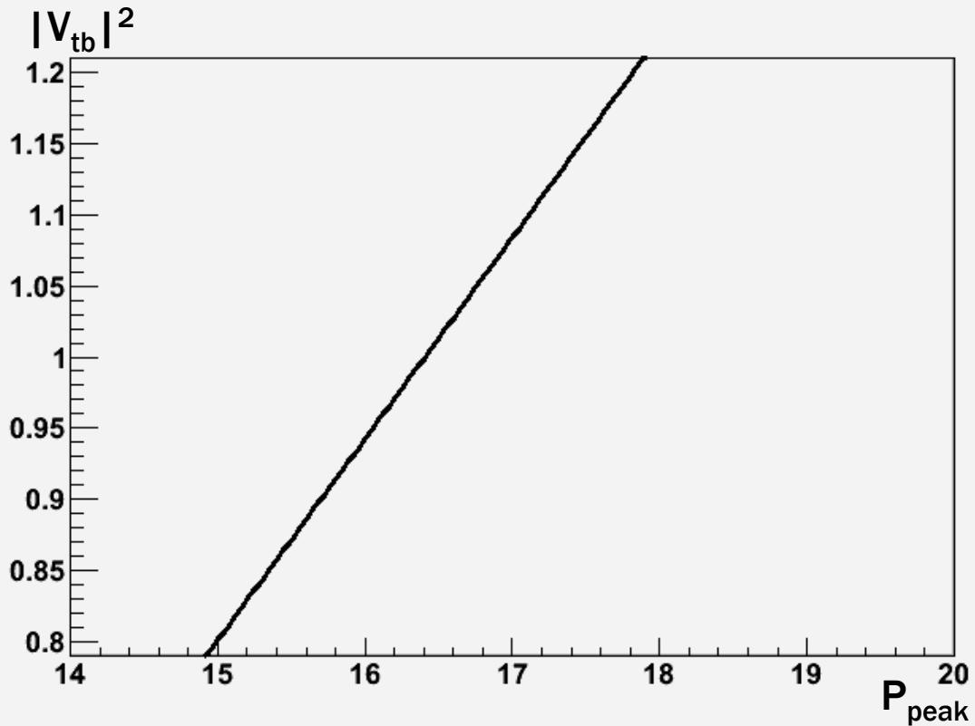
$V_{tb}$ の値を変えた時の運動量のピーク位置を求め、一次関数でfitした。
