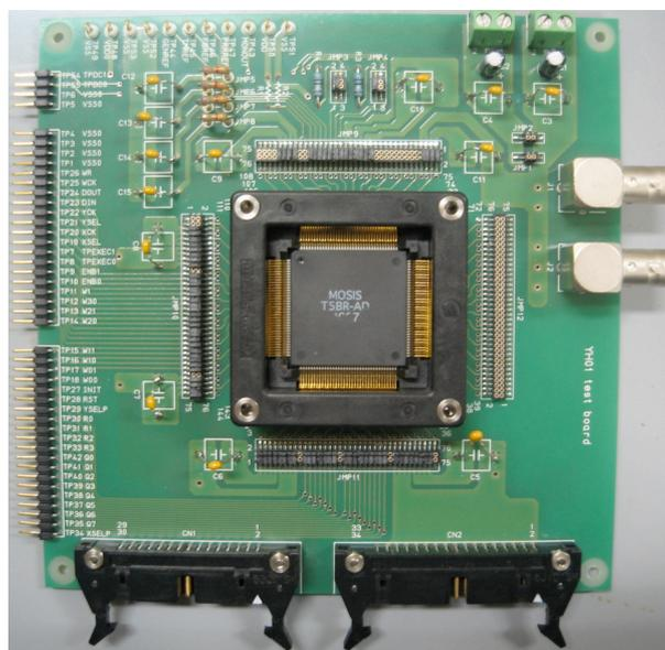
図 4.2: 評価試験用基板。
