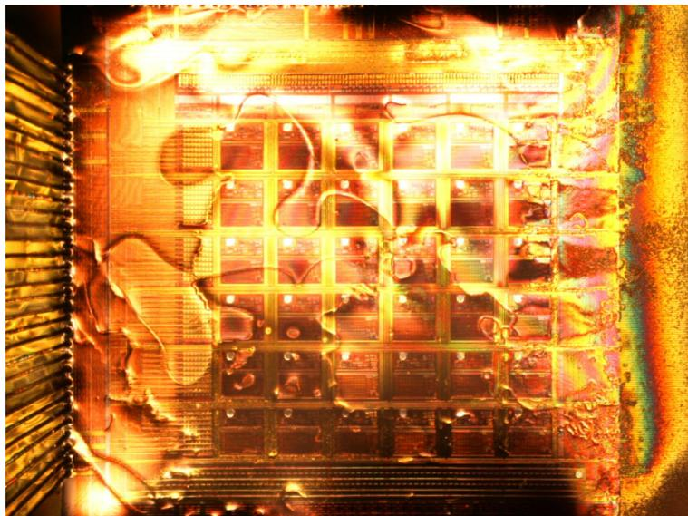
図 5.12: 液晶塗布後。
