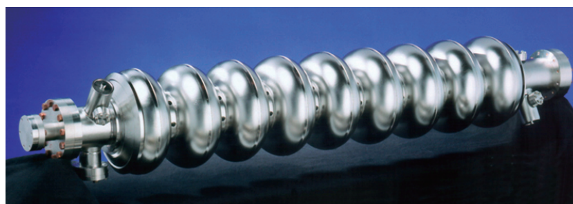
図 3.5: ILC の主線形加速器における 9 個のセルを持つ加速空洞
