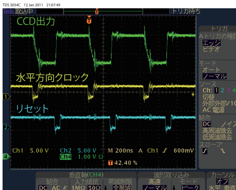
図 6.4: FPCCD 動作試験 : CCD 直後の信号 (緑)、水平方向クロック (黄色)、リセット信号ク (水色)
