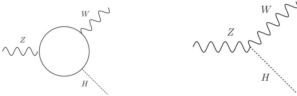
図 2.4: HWZ のループ図。ループ中にはボソン 図 2.5: HWZ のツリーレベルのファインマン図 のほか、新粒子の要素が入る可能性も考えられる。
