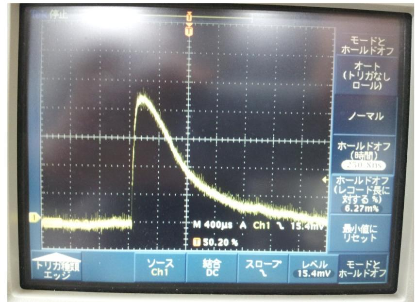
HV 1.6kV オシロ 10mV, 400μs / div
