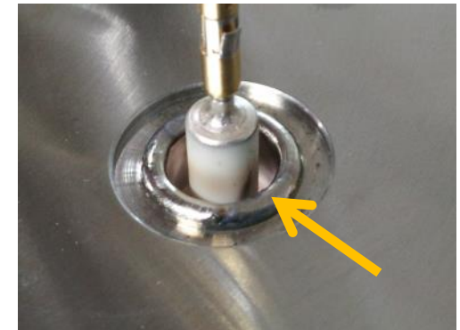
フィードスルーでの放電
