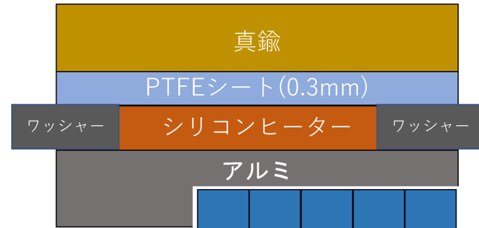
ヒーター（上） 治具の構造
