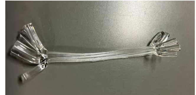
荷重をかけずに恒温槽で加熱して膨張したファイバーの様子
