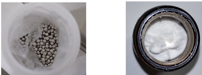
図 4.5: ビンに入った成膜実験に用いた蒸発源。(左) スズ (右) 塩化スズ (II)
