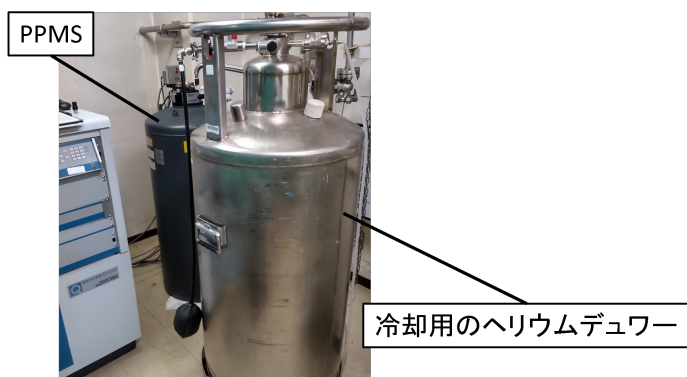
図 5.26: PPMS の外観。PPMS 内の試料は液体ヘリウムで冷却され、ヒーターで昇温される。
