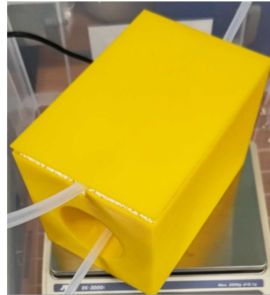
図 5.9 コリメータ箱の内部（左）コリメータ箱の外観（右）。コリメータ内部では、太いチューブと細いチューブをチューブ継手につなぐ配管をしている。太いチューブから冷却空気を送り込むことで、細いチューブからより圧縮された冷却空気を Li ターゲットに送り込むことができる。右の写真ではコリメータの質量を測るためにチューブをコーン型の穴に通しているが、チューブは冷却器の入り口につなぐ [56]。
