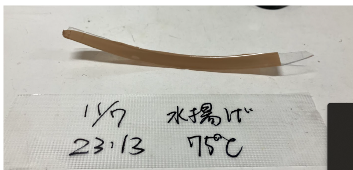
図 5.3: 模擬加速試験のサンプル: 熱膨張率の違いから湾曲してしまった。
