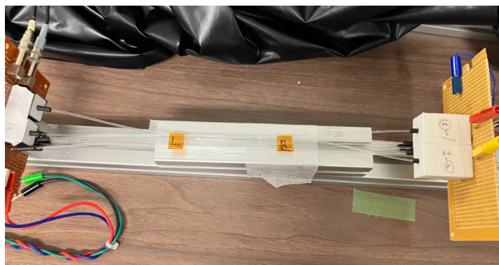
図 4.9: 30cm ファイバー光量測定試験の様子
