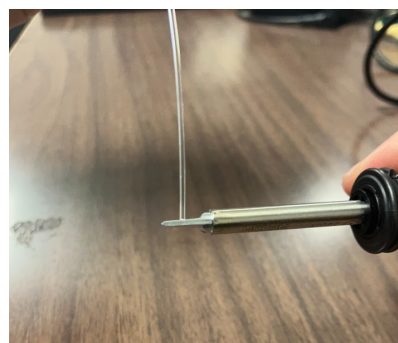
(b) ファイバー端面加熱処理の様子
