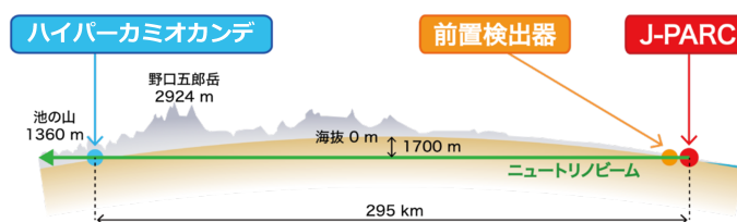
図 1.2: ハイパーカミオカンデによる加速器ニュートリノ振動実験概念図
