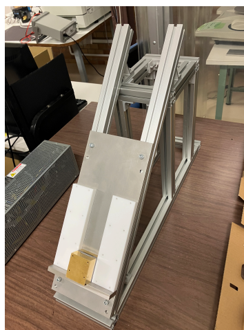
(b) アルミフレームで組み立てた傾斜 45° のスロープにベースモジュールが設置されている。
