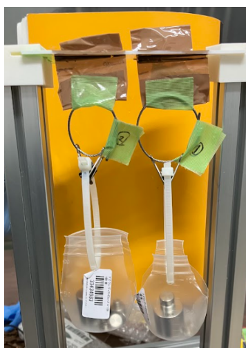
(a) 剥離試験のセットアップ: 荷重をかけて剥離の様子を見る
