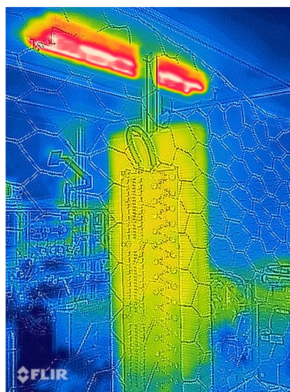
図 5.4: 放電中に赤外線カメラで写した CW
