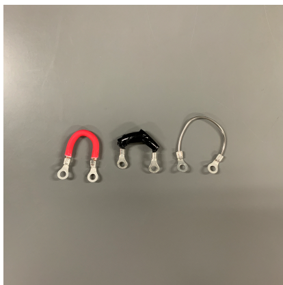
図 5.5: 右から裸単線、被覆単線、ダイヤケーブル
