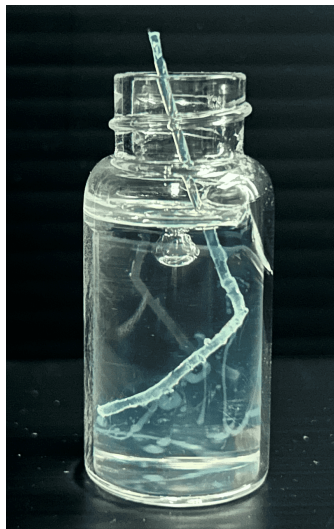
図4.14: サイトップコーティングを21回したファイバーをシンチレータに入れて約8時間温めた時の様子
