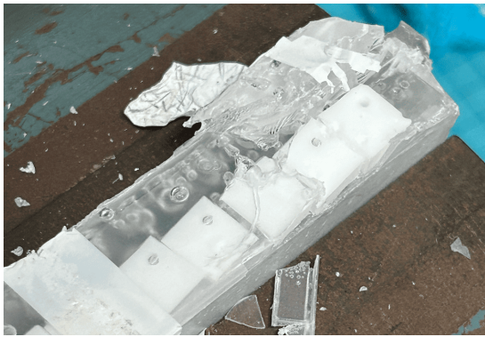
(a) ブロックを包むようにシンチレータが固まっている
