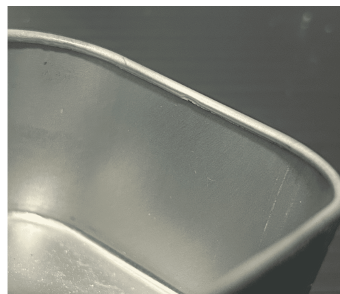
(b) ブリキ缶の上端が内側に織り込まれている
