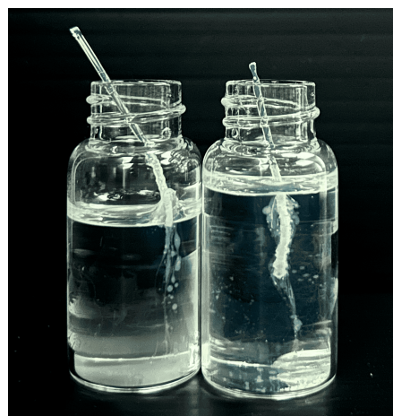
(b) ファイナルバークキュア:80 °C 60 分; コーティング間の乾燥条件: 左室温 30 分, 右 70 °C 10 分
