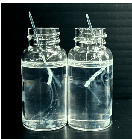
(a) ファイナルバークキュア:80 °C 30 分; コーティング間の乾燥条件: 左室温 30 分, 右 70 °C 10 分
