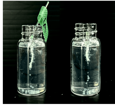
(b) コーティング 1 回; 右側: ファイバーは上に飛び出た部分も脆くなっており、弱い衝撃で折れてしまった。
