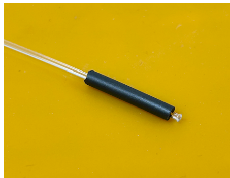
図 4.7: ファイバーに固定用のゴムチューブを取り付けた様子; ゴムチューブの長さ 20 mm, ファイバー端から 3 mm の位置に設置した。
