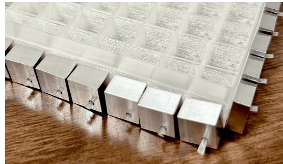
(b) チューブ端がブロックの穴から少し飛び 出す長さに調整した.
