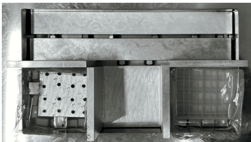
図 5.9: PEN フィルムを使用したシンチレータ製作のセットアップ; 左下と右下の二箇所ですべての大きさのシンチレータを作成.
