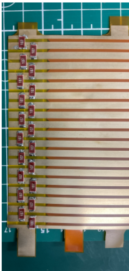
図 24: FPC の銅フィルム各段に 100MΩ 抵抗を取り付けた
