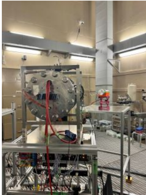
図 14: 実際の検出器配置。キセノンガス検出器から液体シンチレーターを見たもの
