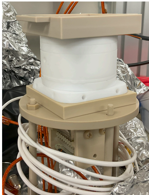
図 5.3 セットアップの画像。白い PTFE 円筒部の中心の壁内部に \alpha 線源である ^{241}\text{Am} が設置してある。
