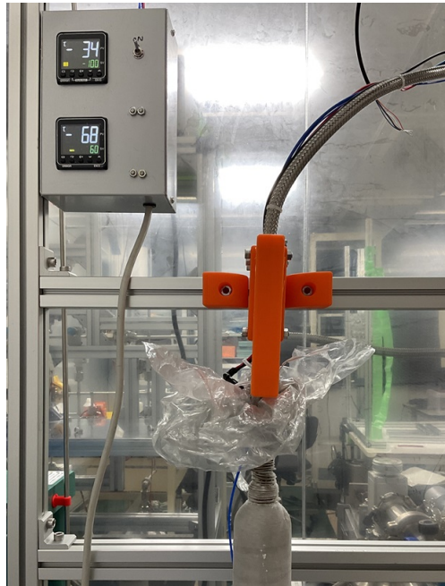
図 5.7 液化回収瓶と温度調整システム付きヒーター。 上のモニターは瓶口の温度、下のモニターは瓶底の温度を表示している。
