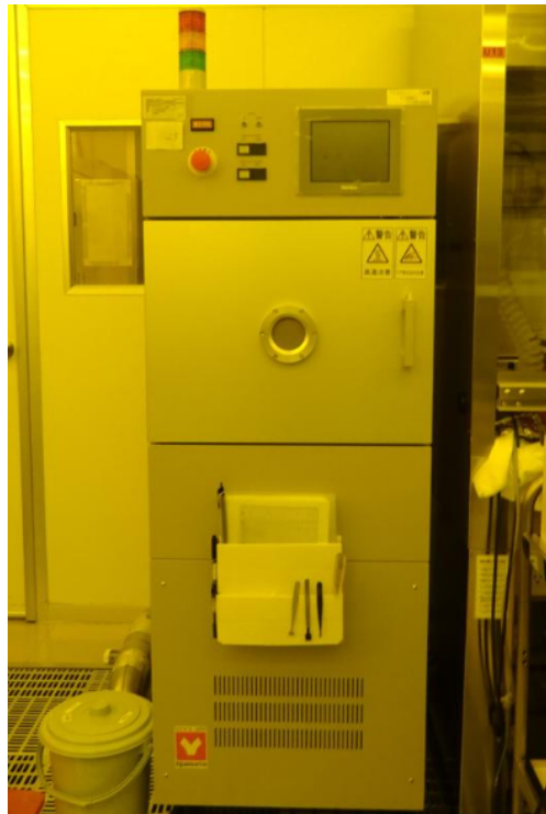
図 4.6 本研究で使用したプラズマアッシャー。東北大学電気通信研究所附属ナノ・スピン実験施設で借用した。
