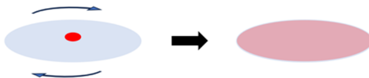
図 4.2 スピンコーティングの概念図。基板中心部に溶液 (図中の赤部) を滴下し、基板を数百 round/min (rpm) と高速で回転させることで溶液を全面に広げる。
