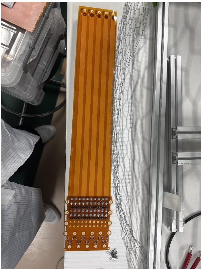
図 15 (左) : FPC コンデンサー用昇圧回路 FPC に接続した FPC コンデンサーの様子
