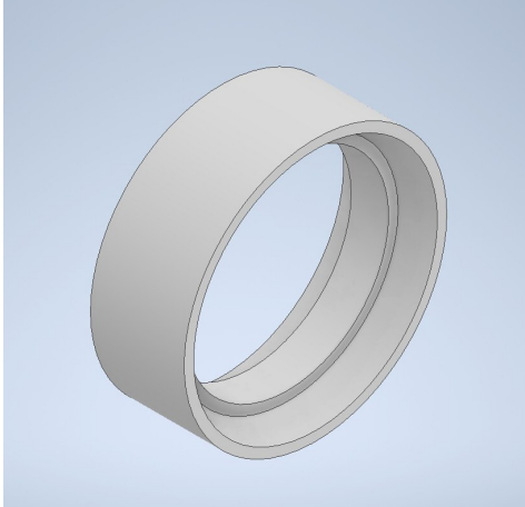
図 4.8: 5 mm 長押さえ治具の 3D モデル
