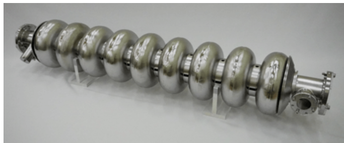
図 1.5: 1.3GHz9cell 空洞の写真 空洞の全長は約 1.2 m である。
