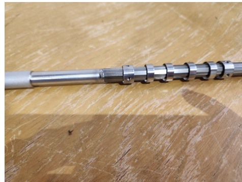
図 4.16: 試作品ベースカソードの溶接部
