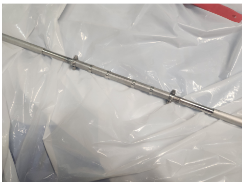
図 4.19: カソードへターゲット固定後の様子
