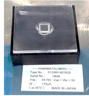
▲ 作成した TPB コート板 (左) と、シンチレーション検出器 (右)
