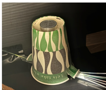
図 3.20: 線源を用いた変換効率測定の様子。線源が紙コップの台の上に置かれている。
