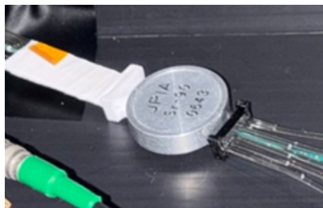
図 3.16: 放射線源を用いた測定の外観。線源が PTFE で被覆されている部分に置かれている。
